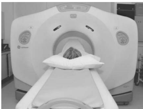
Figura 2-19. Para hacer una TAC, el paciente se coloca en una mesa móvil que lo introduce y mueve con precisión a través del tomógrafo.
