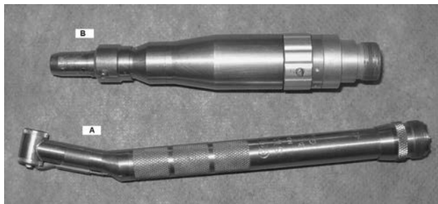
Figura 3-6. A) pieza de alta velocidad, B) pieza de baja velocidad.
