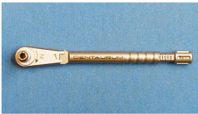
FIGURA 10-47 Los destornilladores para algunos tornillos están diseñados de tal manera que no suministran más de una cantidad de fuerza de torsión controlada, lo que reduce el riesgo de fracturar el tornillo o de ejercer una fuerza excesiva en el hueso.
