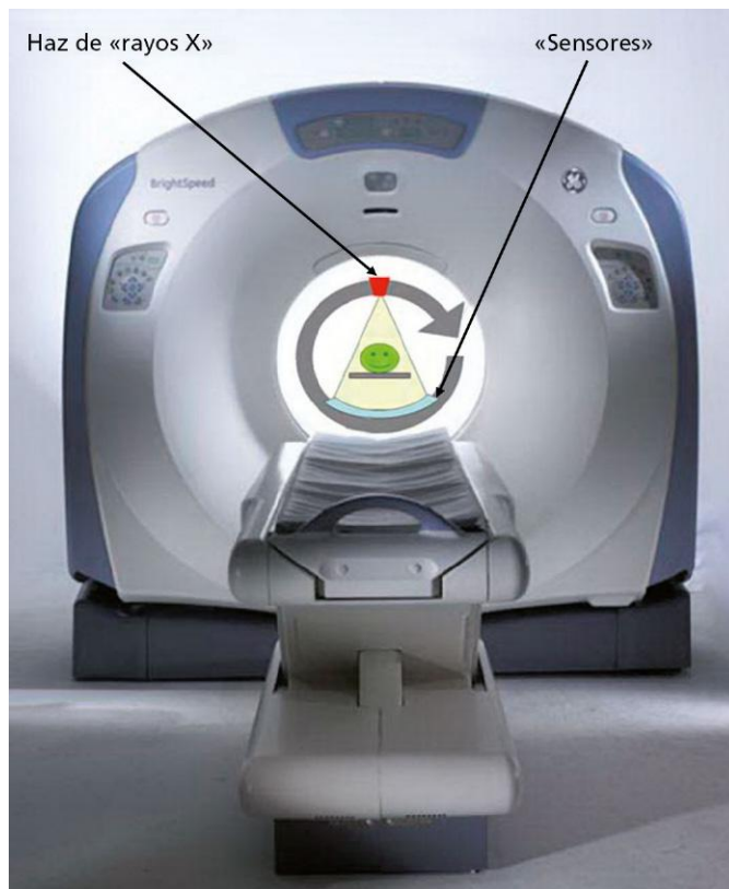
Fig. 3-32 Equipo de TAC-TC. Gantry o grúa y camilla. Sobre la apertura central del gantry se ha superpuesto un esquema que indica la forma en que gira el haz de rayos X.
