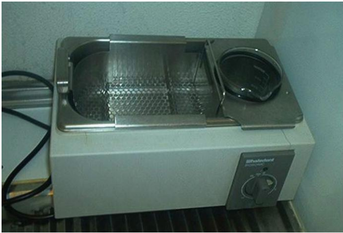
Fig. 8-1 Un ejemplo de cuba para tratamiento de instrumental mediante ultrasonidos.
