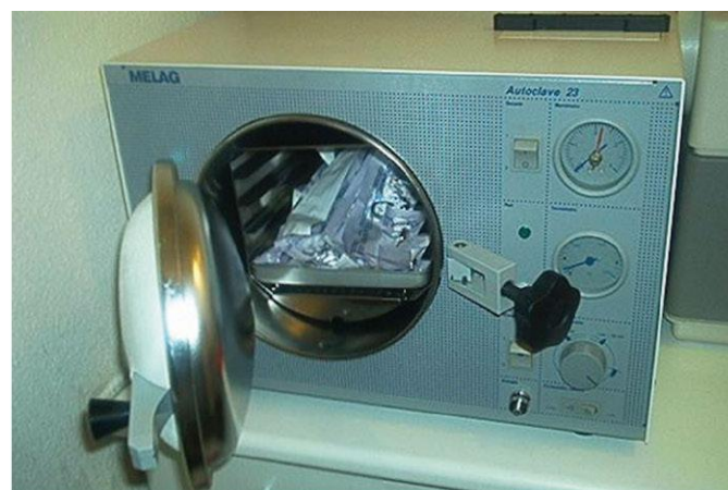
Fig. 8-2 Modelo de autoclave de sobremesa. A. Cerrado. B. Abierto. En su interior muestra diversas bolsas cerradas, con instrumental, listas para ser esterilizadas. Obsérvese el cierre de seguridad del aparato.
