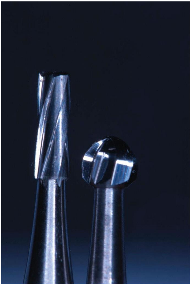
Fig. 8-11 A. Fresas. B. Primer plano de una fresa redonda deteriorada por exceso de uso.
